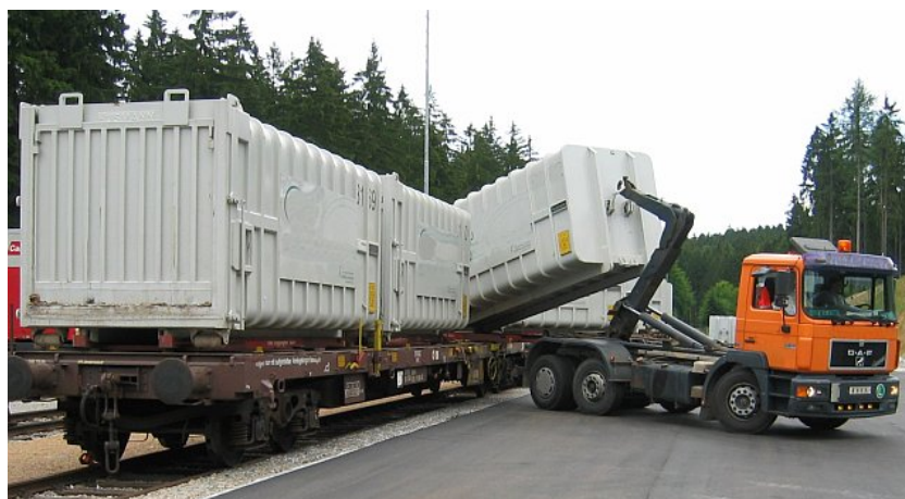
Rys. 6. Przeladunek pojemnika ACTS na wagon o trzech slotach
