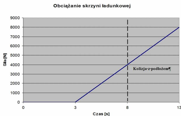
Rys. 5. Badania symulacyjne wirtualnego modelu PMT wskazują na możliwość kolizji kadłuba z podłożem, przy dodatkowym obciążeniu biomasą około 400 kg
