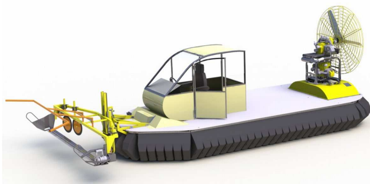
Rys. 3. Wirtualny model PNN w wersji z kosą czołową - przystosowany do holowania Poduszkowcowego Modułu Transportowego.
