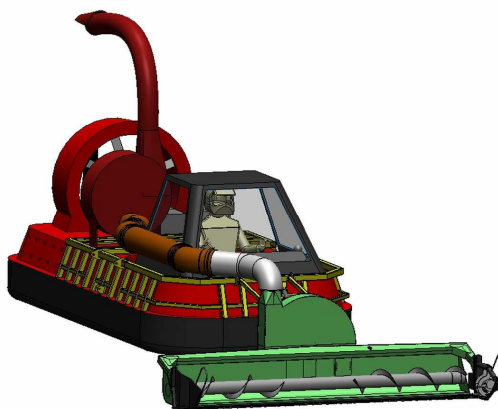
Rys. 1. Wstępna koncepcja Poduszkowcowego Nośnika Narzędzi przystosowanego do koszenia i załadunku pneumatycznego biomasy na Moduł Transportowy
