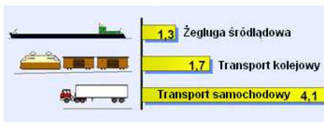
Rys. 1. Zużycie energii w przewozach towarowych realizowanych ŻŚ, transportem kolejowym i transportem samochodowym (w litrach oleju napędowego na 100 tkm)
