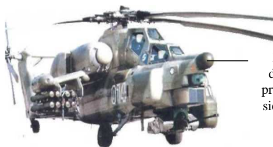
Rys.3. Wariant rozmieszczenia aparatury radiolokatora na śmigłowcu
