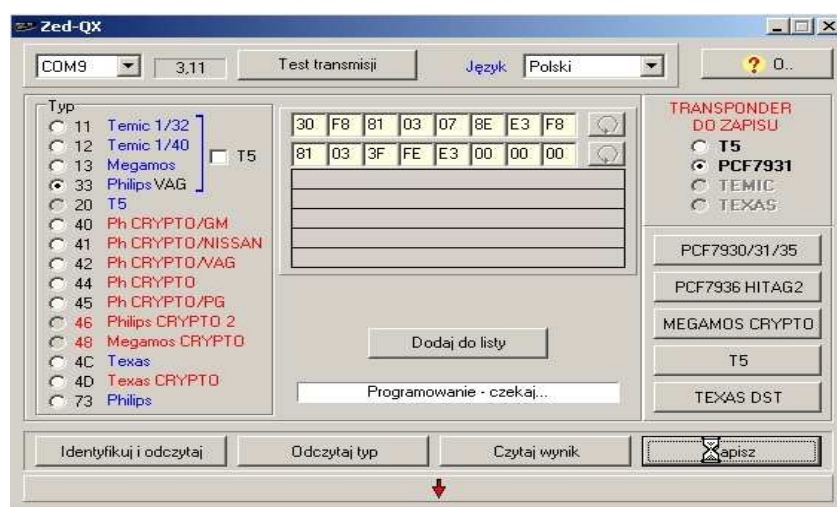
Rys 2. Okno główne programu do obsługi urządzenia Zed-QX, zapisywanie zawartości pamięci elektronicznej nowego transpondera
