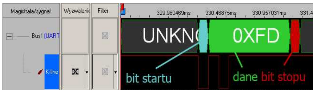
Rys 5. Opis pakietu w oknie roboczym dla magistrali UART
