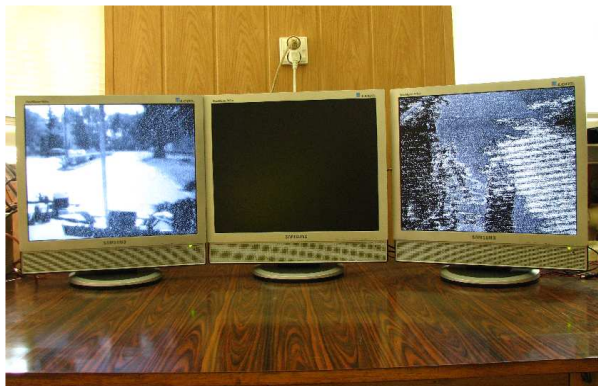
Rys.4. Test dwóch nadajników podczas jazdy z prędkościami powyżej 15 km/h: po lewej obraz z nadajnika pracującego na częstotliwości 1,3GHz, po prawej na częstotliwości 2,4GHz
