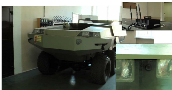
Rys.5. Pojazd Lewiatan 3 z zamontowanym łączem Ethernetowym i kamerami pomiędzy reflektorami oraz z głowicą obserwacyjną
