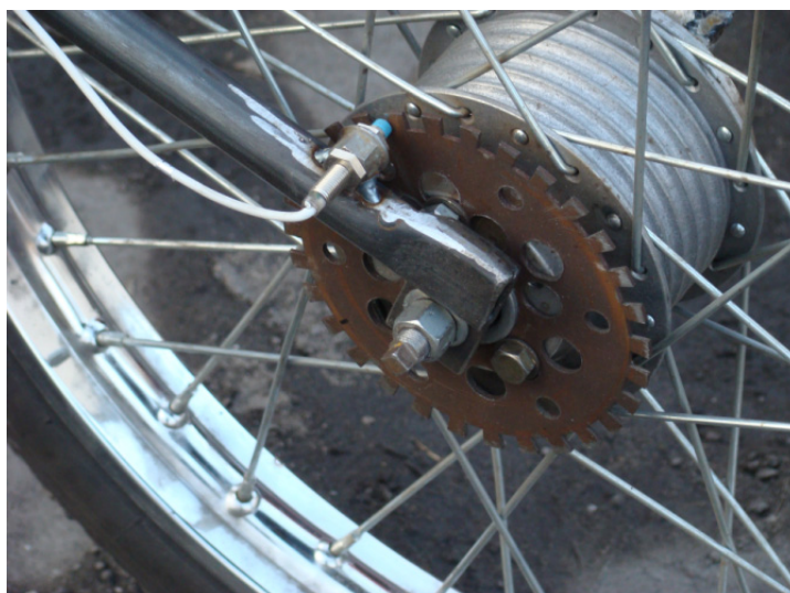
Rys.4. Zamocowanie czujnika IM08-2N5PS-ZW1 na ramie
