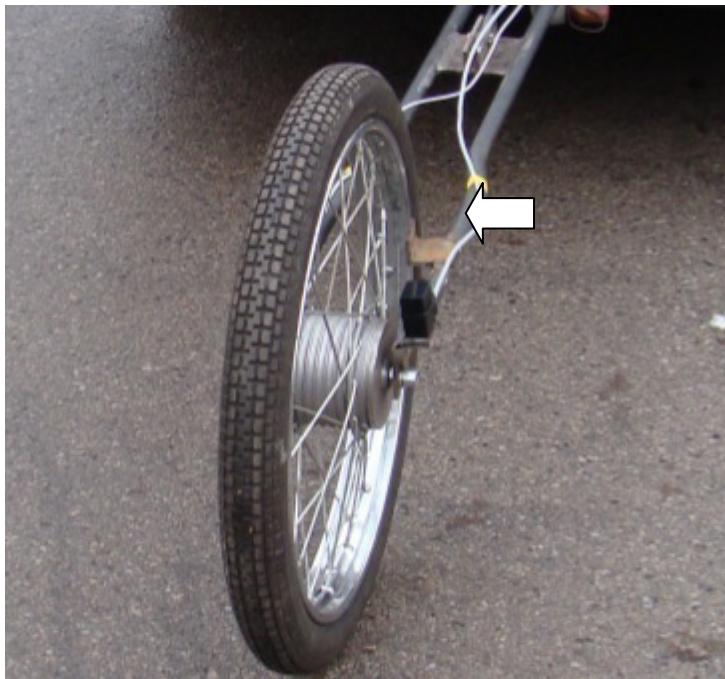
Rys. 3. Widok czujnika przyspieszeń zamocowanego do piątego koła
