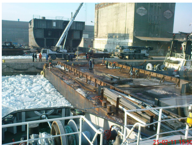
Rys. 4. Zaczepienie pontonu do nabrzeża po pokruszeniu i wychnięciu lodu
