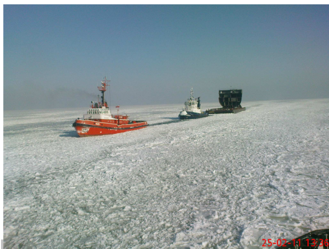
Rys. 5. Zatrzymany przez zalodzenie zestaw holowniczy na torze podejściowym do portu Gdynia
