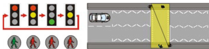
Rys. 6. Sekwencja sygnałów i plan przejścia PELICAN ( http://www.learnerdriving.com/ )
