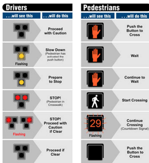
Rys. 8. Sekwencja sygnałów dla pojazdów i pieszych wraz ich znaczeniem dla sygnalizatorów ostrzegawczych HAWK ( http://www.lxinfo.org/ )
