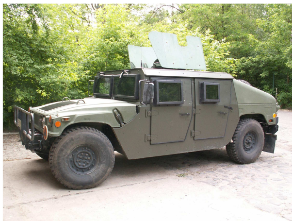
Rys.3. Pojazd wojskowy HMMWV z osłoną balistyczną - lekkim pancierzem kompozytowym
