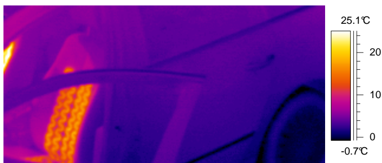
c) termogram fotela kierowcy po 1 minucie od włączenia ogrzewania
