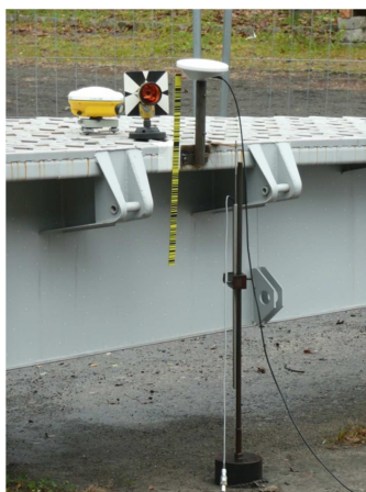
Rys. 7. Instrumenty pomiarowe zainstalowane na przeprawie tymczasowej BLG-67
