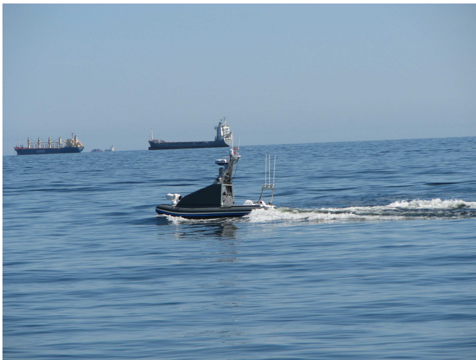
Rys. 4. Próby w morzu bezzałogowego pojazdu nawodnego.
