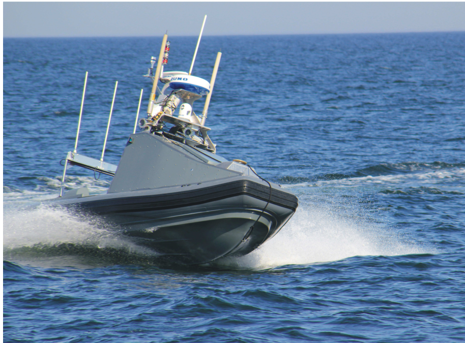
Rys. 3. Próby w morzu bezzałogowego pojazdu nawodnego
