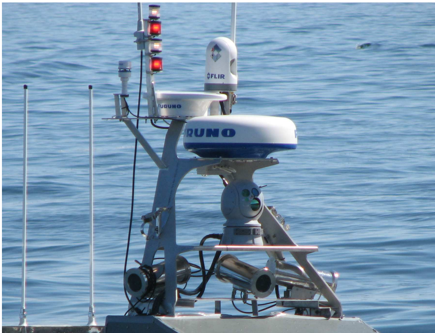
Rys. 2. Maszt z rozmieszczeniem urządzeń nawigacyjnych i optoelektronicznych
