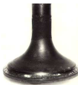
Rys.1. Przykłady zużycia przylgni oraz trzonka zaworów w wyniku eksploatacji.; a – fragmenty grzybka zaworu z przylgniami zużytymi w wyniku korozji gazowej, b – fragment grzybka zaworu z przylgnią zużytą w wyniku korozji gazowej oraz odkształcenia plastycznego,
