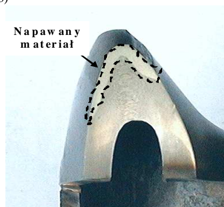
Rys. 2. Przylgni zaworów wylotowych: a) zawór silnika T359E po napawaniu metodą TIG stelliteem typu F6 na bazie Co; b) przekrój zaworu wylotowego silnika ASz62IR z widoczną strefą napoiny wykonanej metodą TIG
