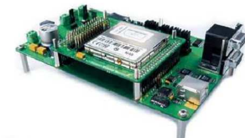
Rys. 2. Zestaw badawczy do testów+moduł Telit 862-GPS
