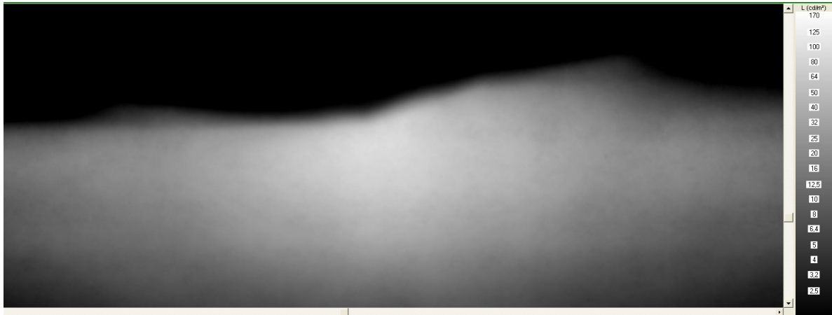
Rys. 4.1.1. Rozkład luminancji na ekranie fotometrycznym, projektor Valeo, źródło światła H7 Tungsram
