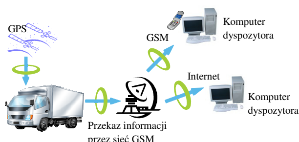
Rys. 4. Ogólny model systemów monitorujących pojazd lub ładunek.
