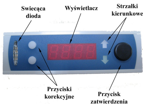
Rys. 2. Wyświetlacz obszarowy systemu Pick by light [3]
