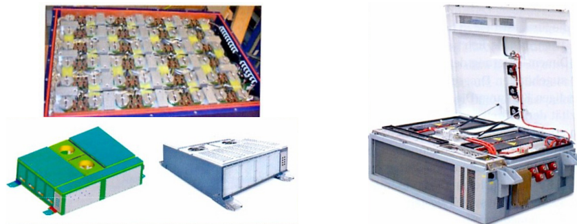
Rys.2. Moduły układu hybrydowego w tramwaju Combino Plus MST (bateria trakcyjna, kondensatory)
