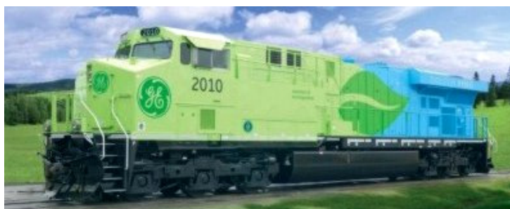
Rys.3. Spalinowa lokomotywa hybrydowa 2010 GE Evolution Hybrid firmy General Electric
