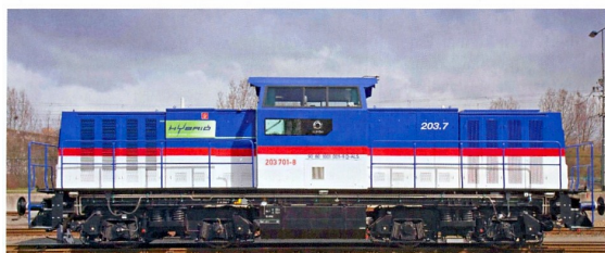
Rys. 4. Hybrydowa lokomotywa spalinowa serii 202 firmy Alstom
