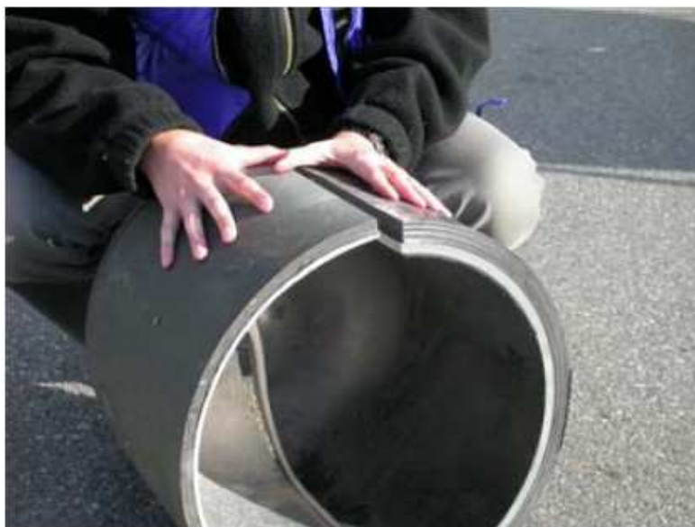
Rys. 3. Porównanie grubości ścianek zbiornika przeznaczonego na ciśnienie 200 bar oraz 700 bar wykonanego z kompozytów typu 3 w postaci cylindra [10]
