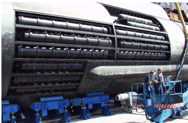
Rys. 5. Cylindryczne zbiorniki z wodorkami metali zainstalowane w zewnętrznym kadłubie okrętu podwodnego 212A
