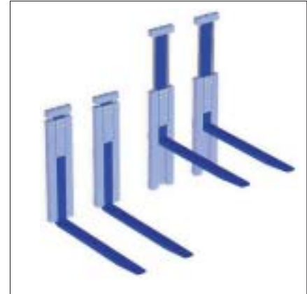
Rys. 9. Podwójny system unoszenia widel [4]
