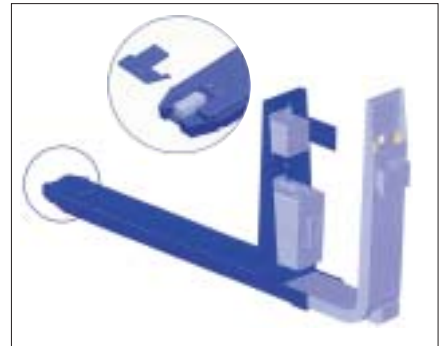
Rys. 6. System kamer w końcówce nosowej widel [4]
