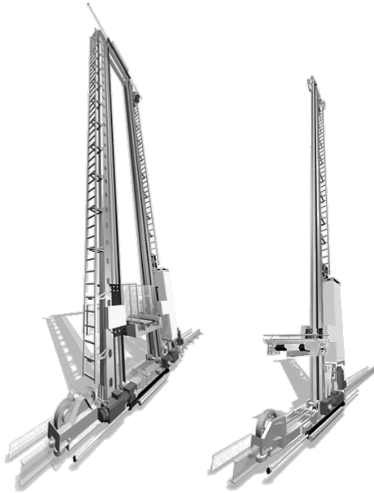
Rys. 2. Automatyczne układnice magazynowe: paletowa i pojemnikowa
