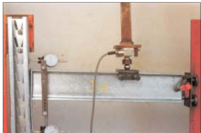
Rys. 17. Stanowisko do badań zaczepu – mierzony kąt obrotu nie zawiera w sobie zarówno lokalnych jak i globalnych odkształceń słupa. Źródło: [11]
