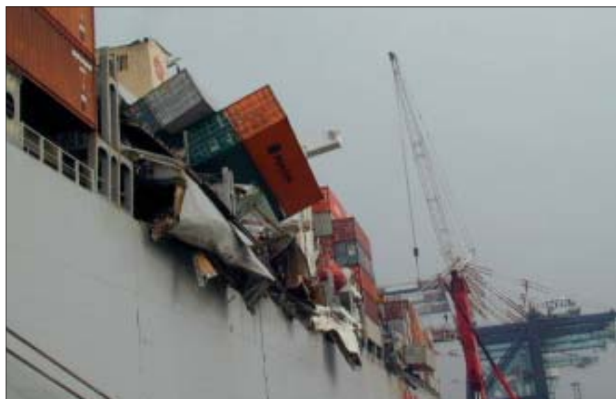
Fot. 2. Uszkodzenia kontenerów (m/v OOCL America). Źródło: www.maxumowners.org
