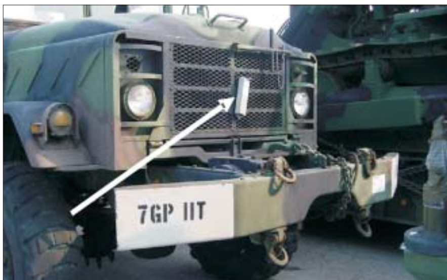
Rys. 4. Przykład umiejscowienia radio-identyfikatora. Źródło: Materiały firmy UNISYS
