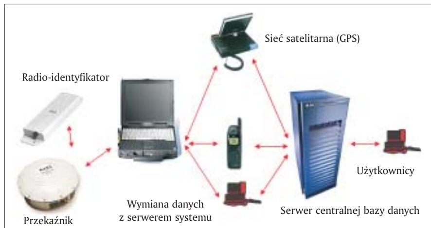
Rys. 1. Infrastruktura systemu śledzenia zasobów logistycznych. Źródło: Opracowanie własne na podstawie materiałów firmy UNISYS.
