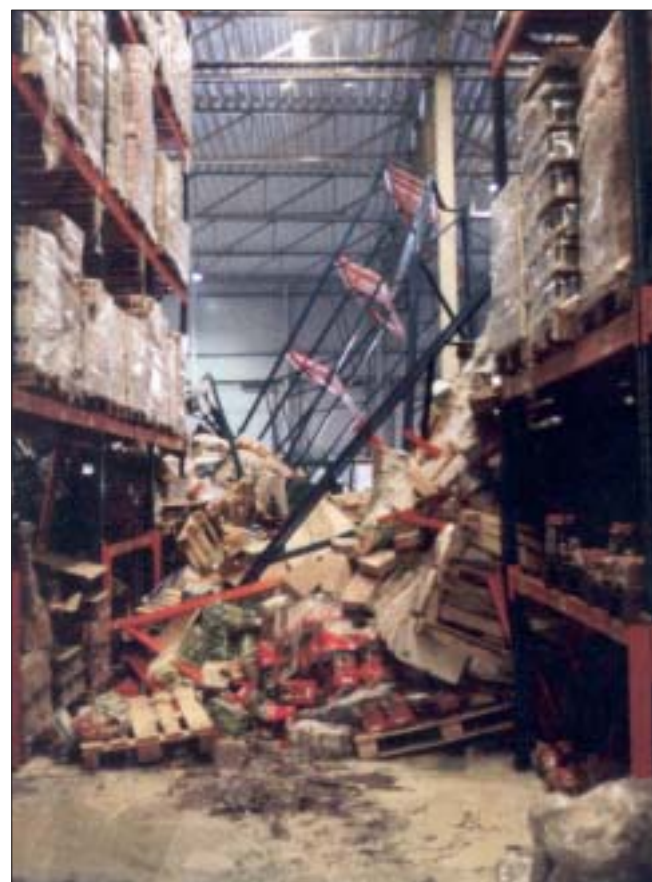
Rys. 1. Katastrofa regałów w magazynie. Źródło: Materiały informacyjne firmy NEDCON
