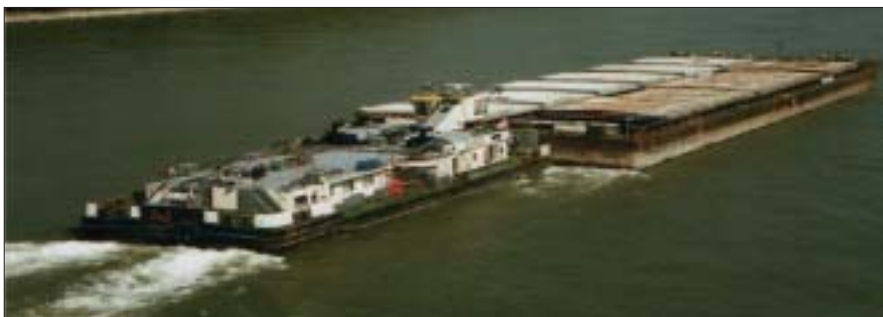
Rys. 3. Zestaw pchany na Dunaju złożony z pchacza i 2 barek pchanych. Źródło: Das System Binnenschifffahrt. W: Handbuch der Donauschifffahrt. Via Donau – Österreichische Wasserstraßen - Gesellschaft mbH, Wien 2005, s.50.
