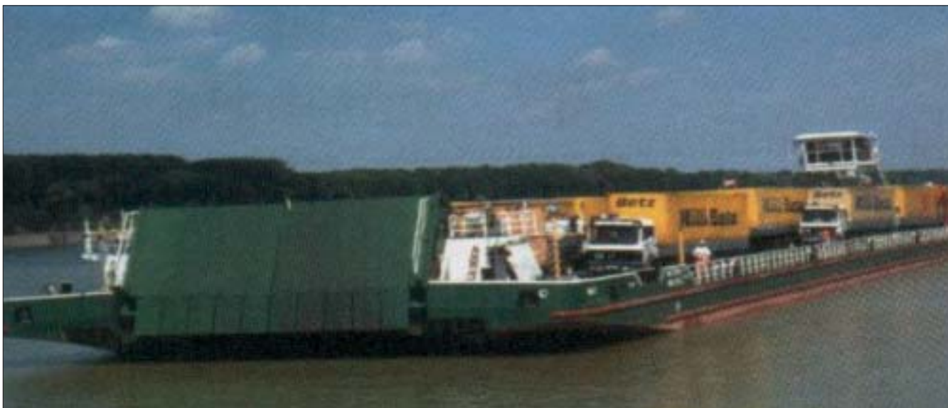
Rys. 6. Statek typu ro-ro przeznaczony do przewozu pojazdów drogowych. Źródło: Das System Binnenschifffahrt. W: Handbuch der Donauschifffahrt. Via Donau – Österreichische Wasserstraßen - Gesellschaft mbH, Wien 2005, s.46.
