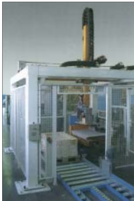
Rys. 3. Układ zrobotyzowany firmy Rober z widocznym urządzeniem ochronnym i urządzeniem stopu awaryjnego.
