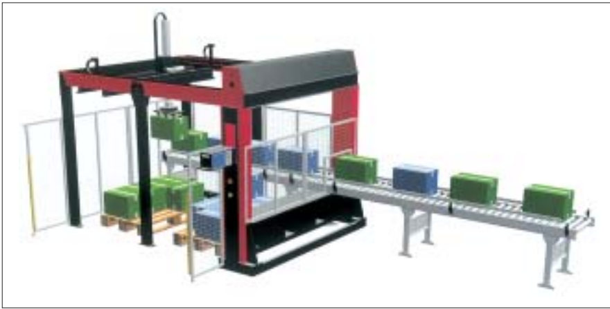
Rys. 2. Paletyzujący układ zrobotyzowany firmy Soco System z widocznym urządzeniem ochronnym i panelem sterowania.
