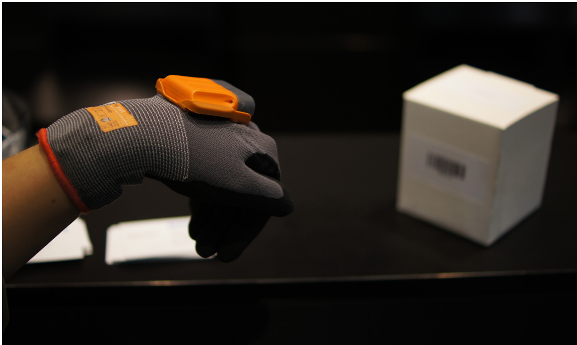
„Inteligentna rękawica” ze skanerem kodów kreskowych firmy ProGlove. Fot. Rafał Rokicki
