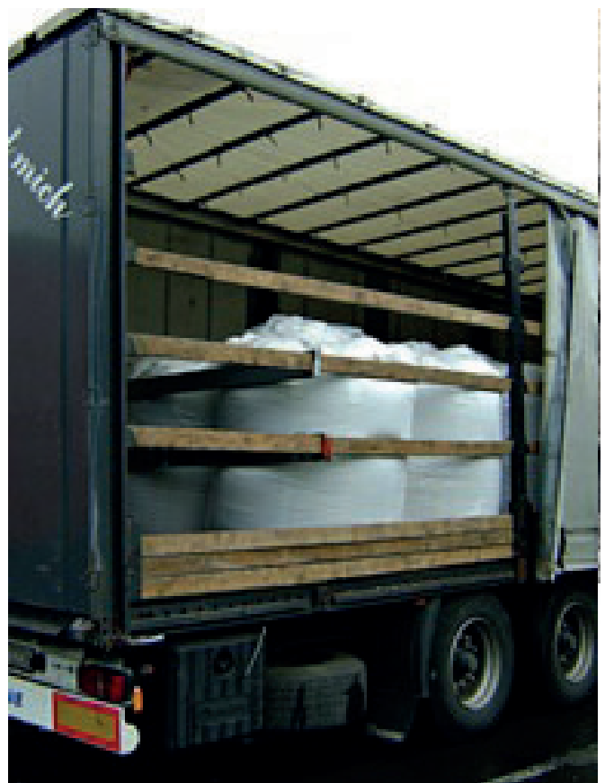
Rys. 3. Worki BigBag z żelazostopami umieszczone w naczepie pojazdu ciężarowego Źródło: Kubica-Klaczak M., Międzynarodowy przewóz żelazostopów , Praca dyplomatyczna magisterska, Politechnika Śląska, Katowice, 2012.
