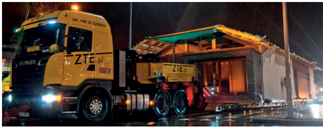
Rys. 5. Kesselbrücke – naczepa przewożąca dom modelowy. Źródło: ZTE Sp. z o.o. Sp.K.
