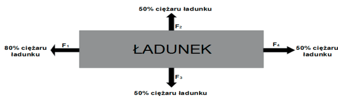
Rys. 6. Rozkład sił działających na ładunek. Widok z góry ładunku. Źródło: opracowanie własne na podstawie [3, 5].
