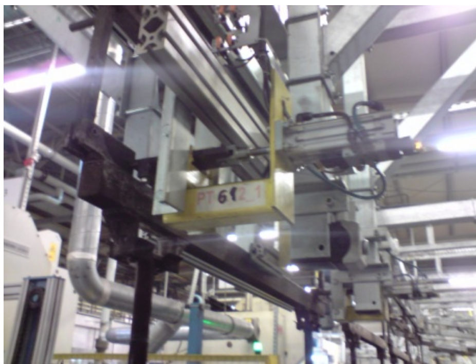
Fot. 3. Belka trawersowa (zablokowana stoperem); (źródło: opracowanie własne).
