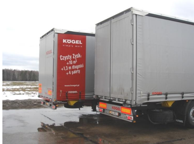
Rys. 4. Naczepa o normatywnej wartości długości i naczepa wydłużona o wartość 1,3m Źródło: opracowanie własne
