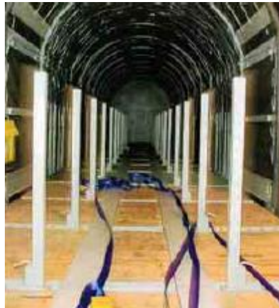
Rys. 9. Ruchome kłonicie, z możliwością przesunięcia na boki [1]
