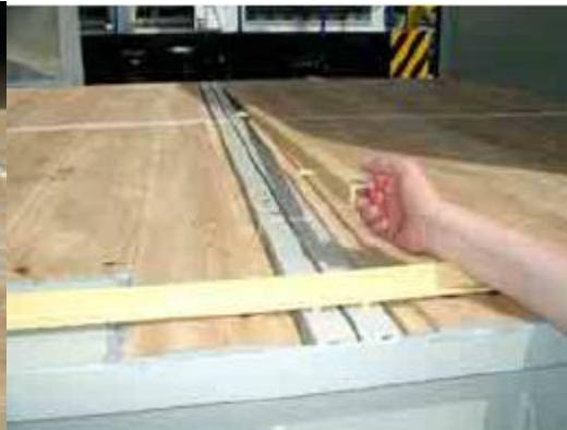
Rys. 6.a) profile zamocowane wzdłuż ścian wagonu, b) profile umieszczone w prowadnicach podłogi [1]
