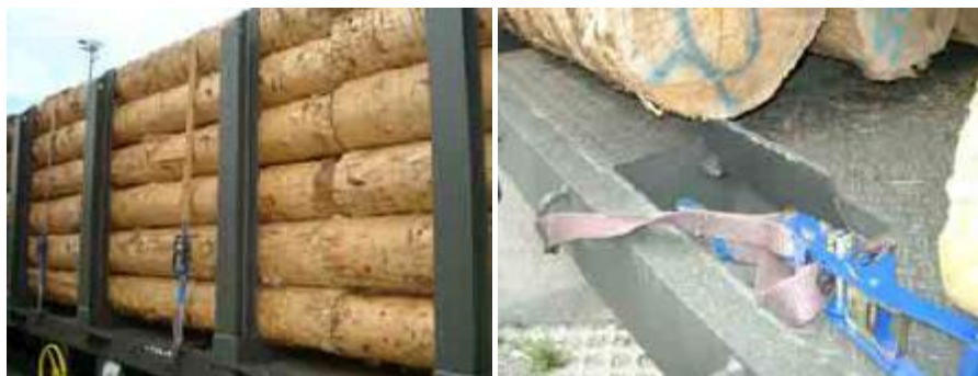
Rys. 12. Przykład zabezpieczenia drewna na platformie kolejowej [1]
