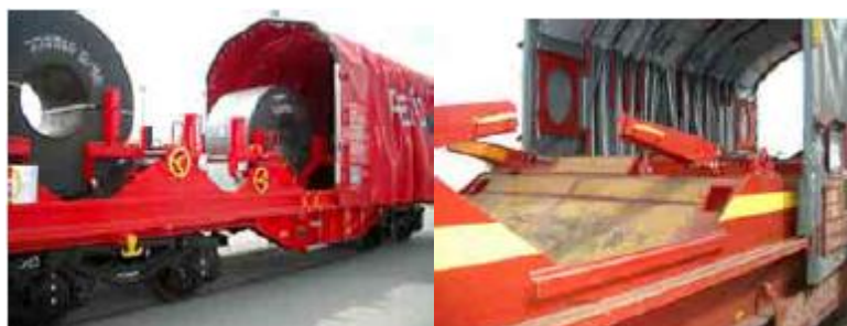
Rys. 10. Muldy dla blach w kręgach z ramionami mocującymi [1]
