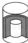
Zbiornik wewnętrzny umieszczony w większym pojemniku metalowym, wolną przestrzeń do górnej krawędzi zbiornika wewnętrznego wypełniono betonem
