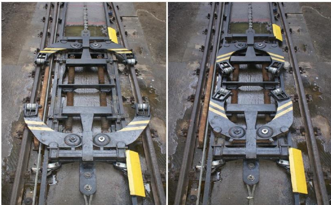
Rys. 2. Przeciągarka wagonowa montowania w torowisku (typu UT-7, UNITOR)
