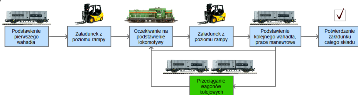
Rys. 1. System załadunku wagonów kolejowych – schemat poglądowy
