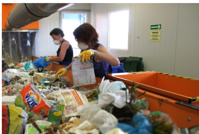
Fot. 3. Ręczne sortowanie odpadów zmieszanych. Źródło: materiały z firmy RIPOK.
