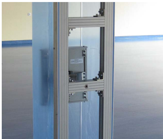
Rys. 12. Fragment bramki wykonanej w ILiM z widoczną anteną RFID.
