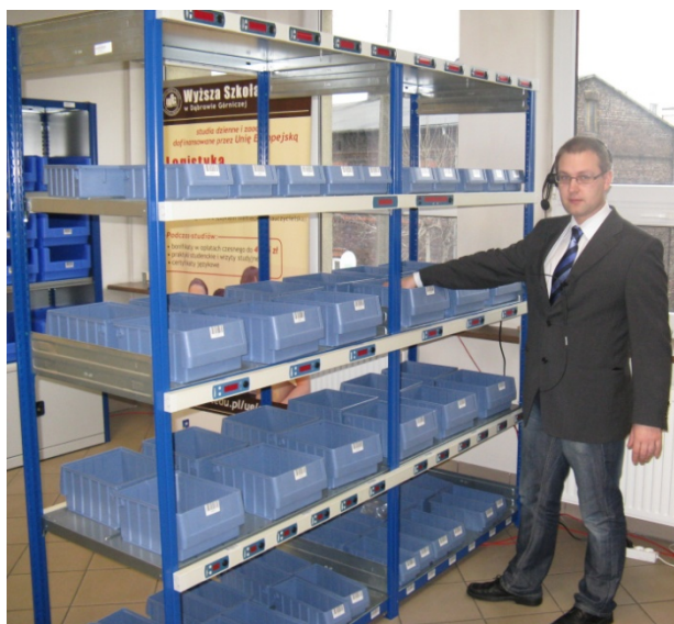
Rys. 2. Pracownik wyposażony w zestaw mikrofonowo-słuchawkowy systemu Pick by voice [5]
