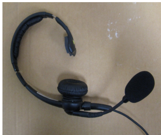
Rys. 1. Przykładowy zestaw słuchawkowo-mikrofonowy wykorzystywany w systemie Pick by Voice [5]
