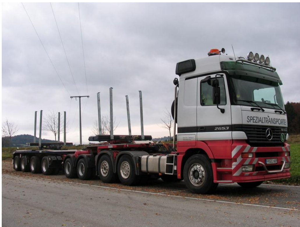
Rys. 5. Pojazd dłuźycowy składający się z ciągnika siodłowego 6x2 z dwuosiową naczepą z obrotową podporą oraz czterosiowy wózek (nachläufer) z obrotową podporą. Źródło: opracowanie własne
