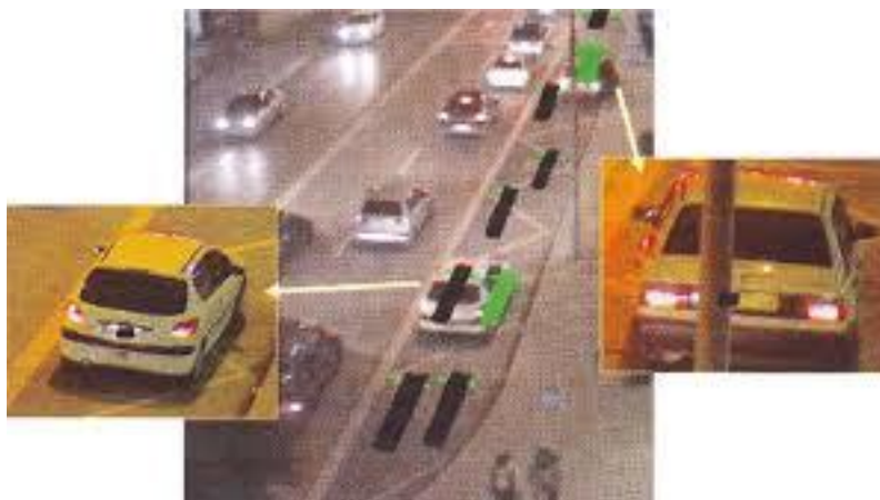
Rys.2. Obraz z kamery ilustrujący działanie wideo-czujnika [7]
