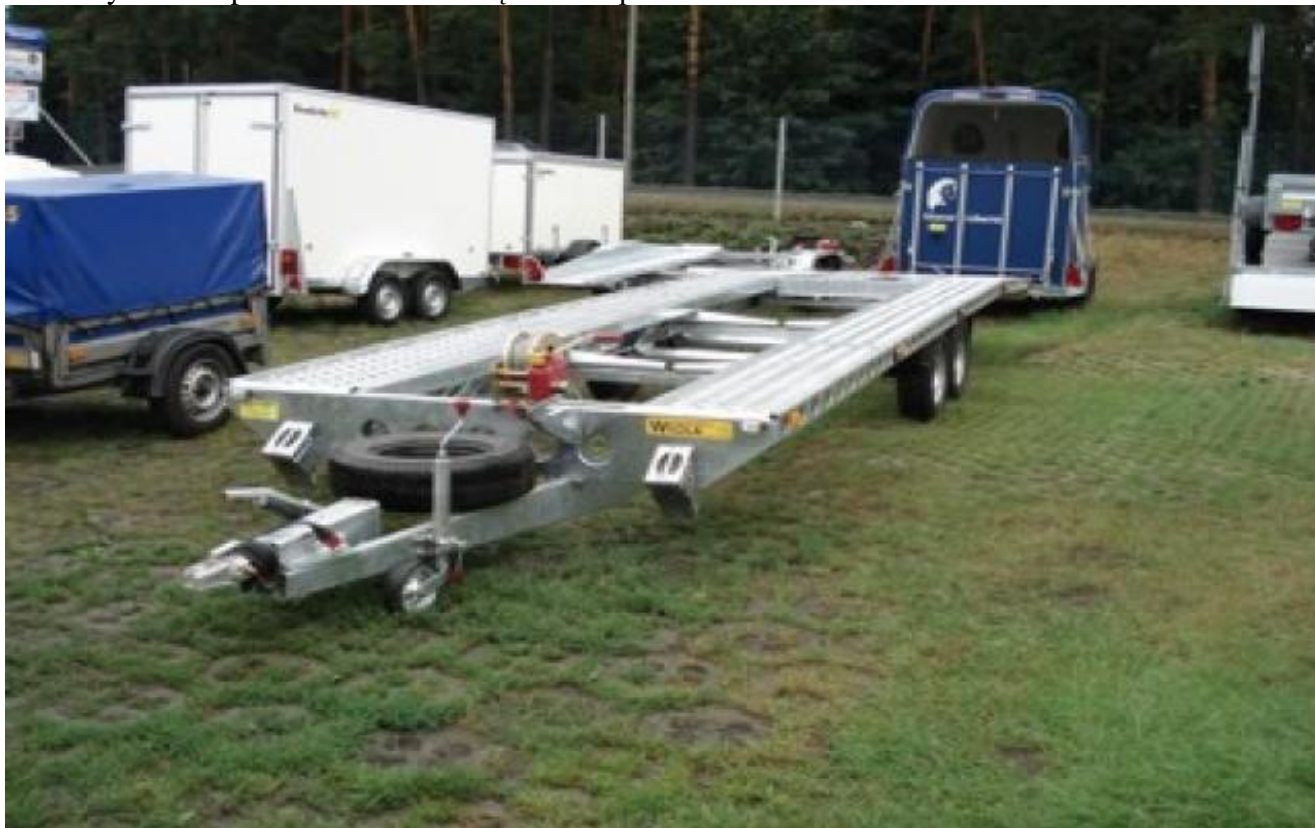
Rys. 1. Laweta do transportu samochodów. Źródło: http://www.admoto.pl
