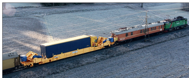
Fot. 1. Transport zestawu na wagonie platformie działającego w systemie Flexiwaggon. Źródło: http://stockholmgroup.org/
