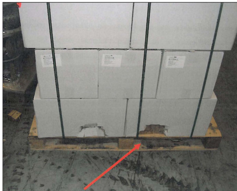
Fot. 2. Uszkodzenie spowodowane widłami wózka unoszącego. Źródło: archiwum Autorów.
