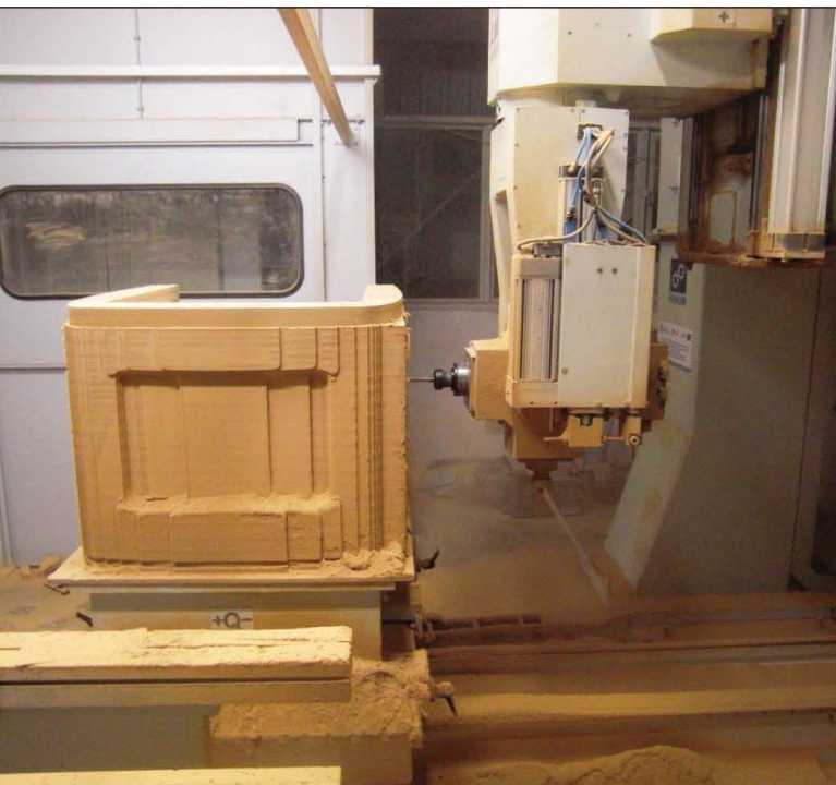
Rys. 4. Proces frezowania formy na frezarce CMT. Źródło: opracowanie własne.
