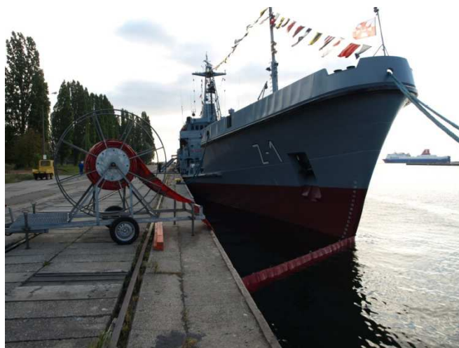
Rys. 2. Wykorzystanie zapory przeciwolejowej podczas bunkrowania paliwa Źródło: materiały własne
