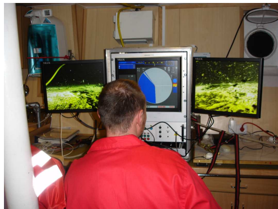
Fot. 3. Nowy pulpit stanowiska kontroli i sterowania jednostką głębinową ROV
