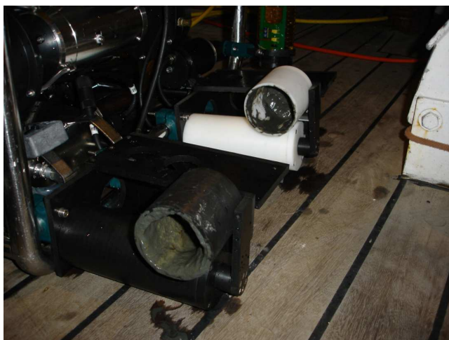
Fot. 2. Zasobniki do pobierania próbek materiału dennego
