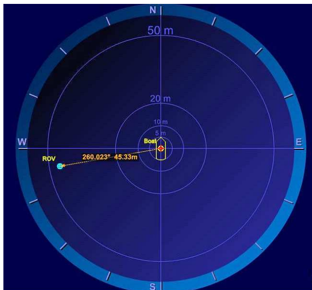
Rys. 3. Zrzut ekranu systemu nawigacji podwodnej w chwili kontaktu z obiektem O1
