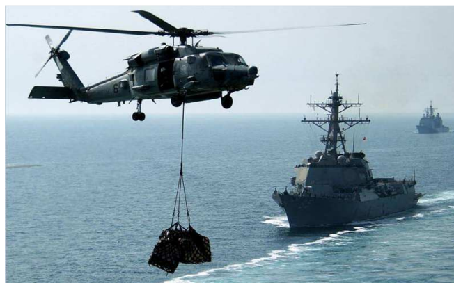
Rys. 1. Przekazywanie ładunków metodą VERTREP z wykorzystaniem sieciopalet Źródło: http://www.seaforces.org/usnships/ddg/DDG-85-USS-McCampbell.htm , [31.08.2012]
