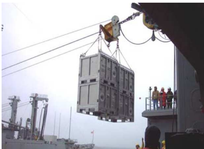
Rys. 6. Transport kontenerów typu JMIC pomiędzy okrętami przy wykorzystaniu metody CONREP
