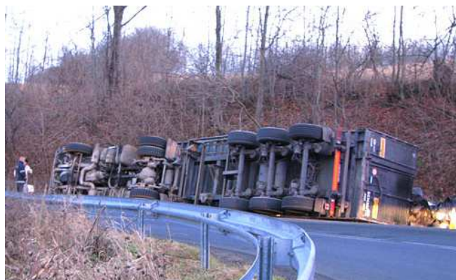
Rys. 4. Przykład wywrócenia się na zakręcie przeciążonego zestawu kontenerowego
