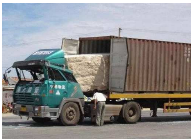
Rys. 3. Przykład efektu hamowania z przeciążonym i błędnie umocowanym kontenerem
