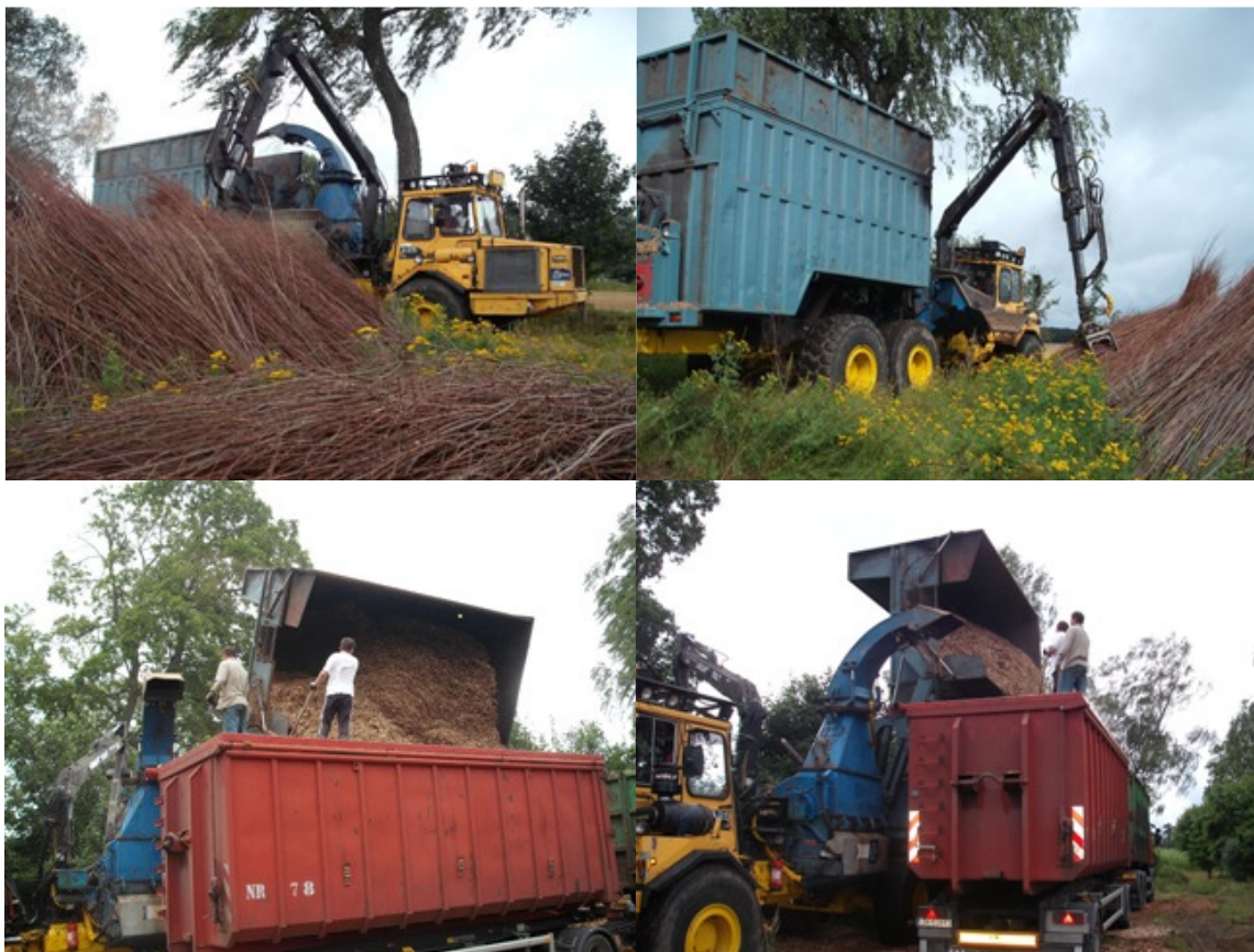
Rys. 1. Proces zrębkowania wierzby i przygotowania biomasy do transportu
