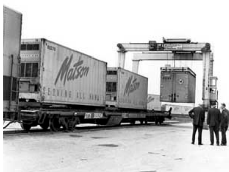
Rys.14. Pierwsza suwnica z narożnikową chwytnią kontenerową na terminalu Matson Navigation Co. Encinal Terminal w Alameda, California, 7 stycznia 1959r
